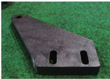
SS400 16mm ブラケット レーザ加工品 Sản phẩm cắt laze Braket SS400-16mm
