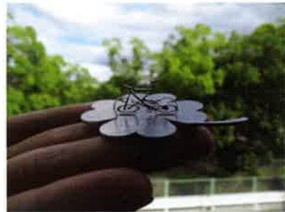
SUS304 1mm 自転車 Xe đạp được cắt từ thép SUS304 1mm
