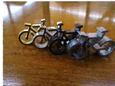
SS400 9mm-SUS304 10mm-AL 6mm 真鍮 6mm レーザ加工品 Sản phẩm cắt laze theo thứ tự: SS400 9mm-SUS304 10mm- Nhôm 6mm- Đồng thau 6mm
